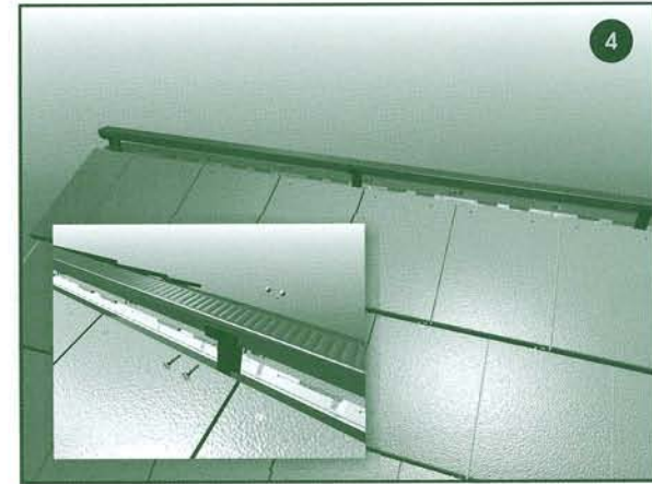
ยึดเหล็กรับครอบติดกับขาเหล็ก ด้วยตะปูเกลียวยึดแปจำนวน 4 ตัว โดยเหล็กรับครอบต้องอยู่ในระดับเดียวกัน และอยู่ในแนวกึ่งกลางสันหลังคา
