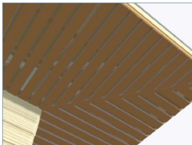
รูปที่ 2 : แสดงการติดตั้งไม้ระแนงเฌอราแบบเว้นร่อง
