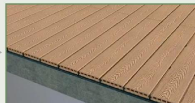
12. ติดตั้งไม้พื้นด้วยวิธีเดียวกันจนสุดระยะ โดยแผ่นสุดท้ายให้ยึดสกรูที่แผ่นหรือยิงยึดแบบที่ด้านข้างแผ่น
