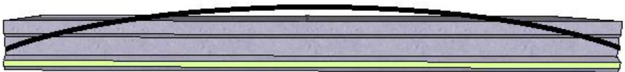
รูปที่ 25 แสดงการโก่งของแผ่นพื้น Hollow core
