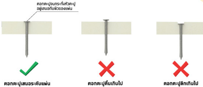
รูปการยึดแผ่นพื้น เฌอรา บอร์ด ด้วยตะปู
