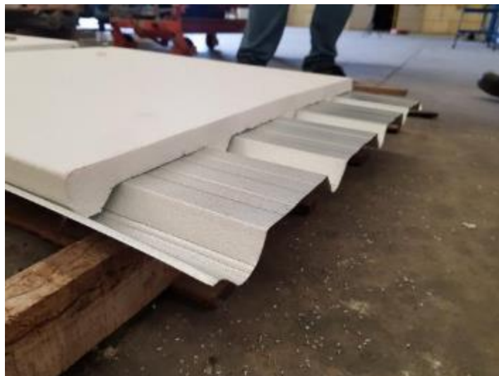
ปิดเศษเหล็กออกจากแผ่นหลังคา พร้อมทั้งขีดและ ทำความสะอาดพื้นผิว
